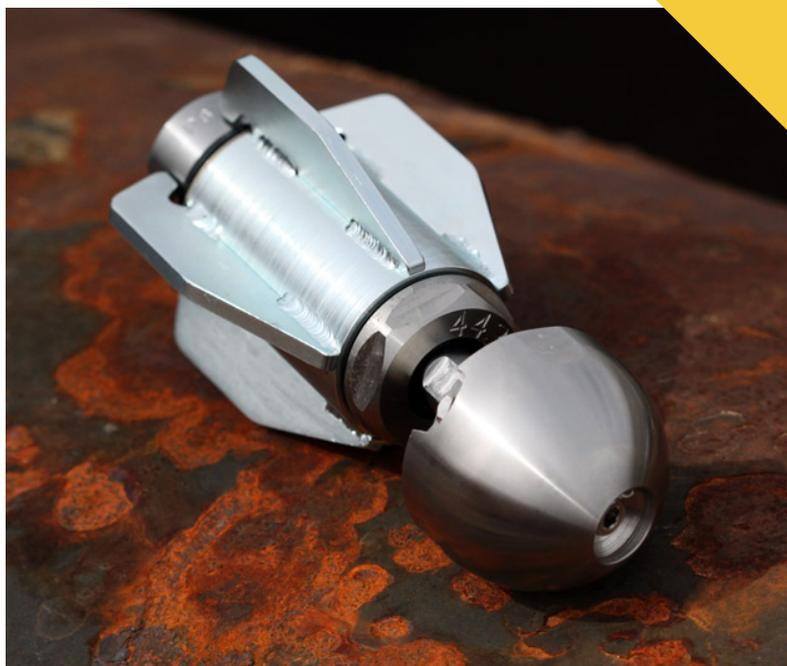
Конструкция новой насадки WHP-3/4 позволяет производить большее тяговое усилие по сравнению со всеми существующими в настоящее время инструментами. Задние форсунки формируют струи, расположенные под более острым углом, а ребра центратора имеют скос назад.
