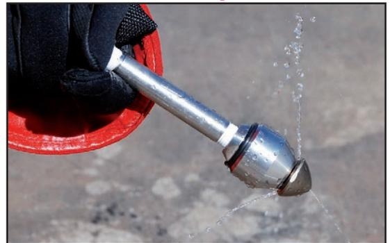
При применении WV-1/4™ в трубах диаметром свыше 4" необходимо устанавливать жесткое копьё между входным портом инструмента и концом шланга. В противном случае возможно закручивание инструмента внутри трубы (как показано на рис. ниже) и выход его назад к оператору, что может привести к серьезным авариям или смертельному исходу.
