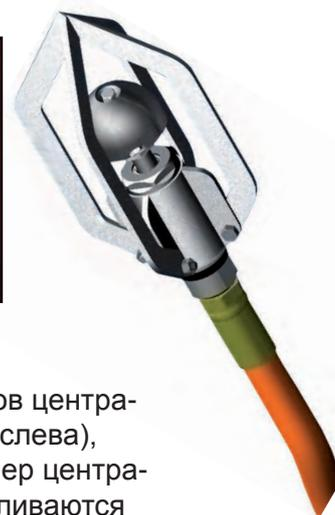
Предлагается несколько различных типов центраторов, включая многоколесные (см.рис. слева), многореберные (см. рис. в центре) и супер центраторы (см. рис. справа), которые устанавливаются прямо на корпус инструмента.
